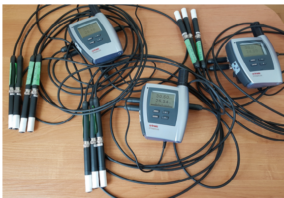
Zdjęcie. 3. Zestaw 10 sond termohigrometrycznych
