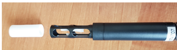
Zdjęcie. 4. Sonda termohigrometryczna
