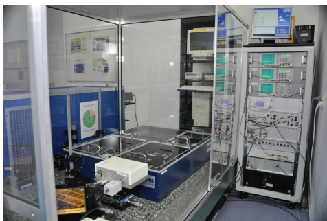
Rys. 3. Pierwotny wzorec długości – syntezer częstotliwości optycznych
