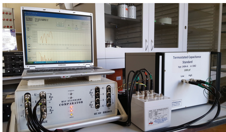
Rys. 5. Widok układu pomiarowego z komparatorem RLC 2100 i kondensatorami wzorcowymi Fig. 5. RLC 2100 measurement system
