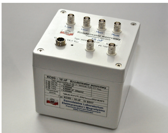
Rys. 2. Widok kondensatora wzorcowego 10 nF zbudowanego w GUM Fig. 2. Capacitor 10 nF, made by GUM
