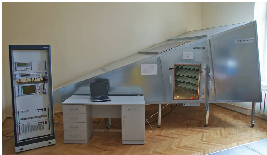
Rys. 1. Widok komory GTEM w GUM
